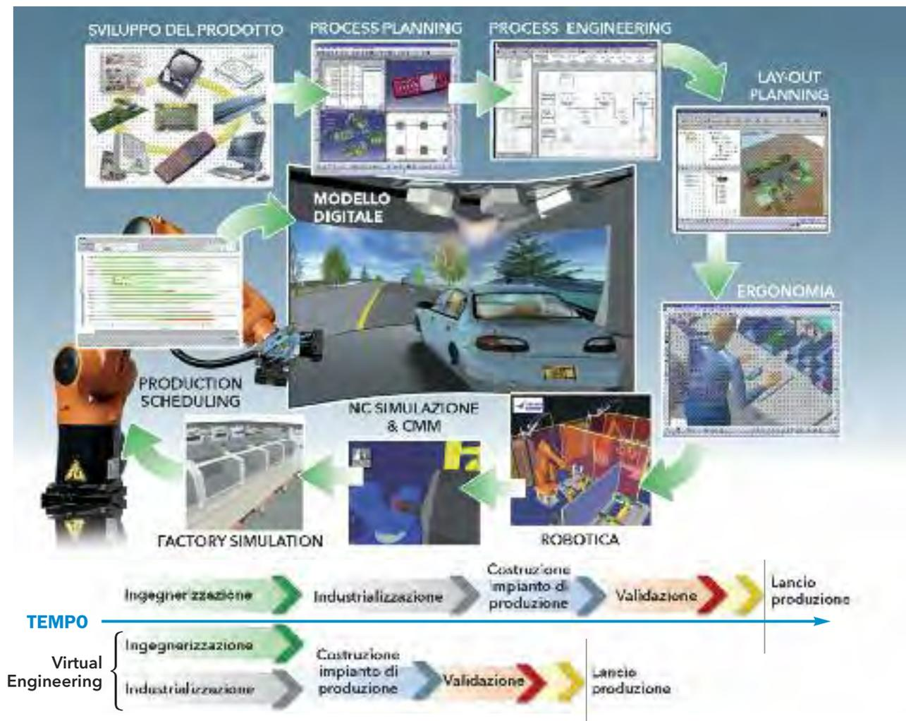
▲ Fig. 21. Il digital manufacturing permette di simulare le attività di produzione, includendo risorse umane, robot, macchine e flussi di materiali con rilevanti risparmi di tempo e costi.
