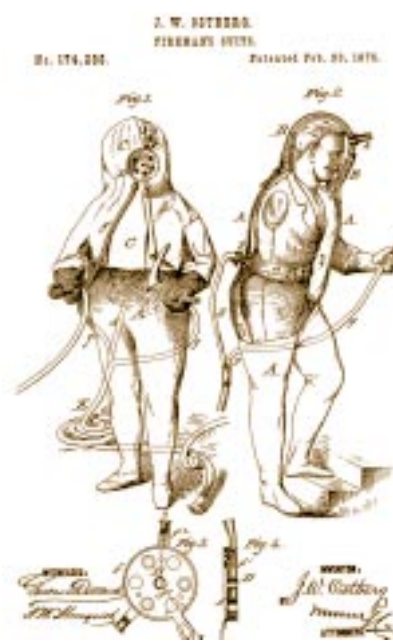
Brevetto di scafandro (1876) destinato ad essere utilizzato dai vigili del fuoco
